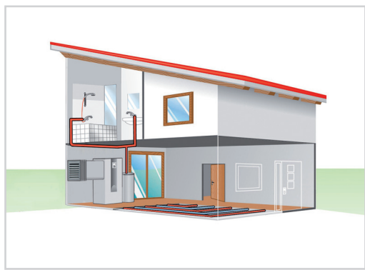
Application PAC Air/Eau intérieure Compact pour un circuit de chauffage et préparation d'eau chaude sanitaire.
